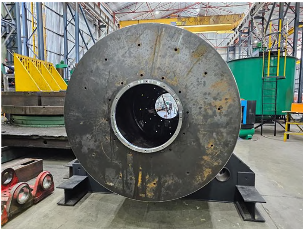
Figure 1 – Préparation du broyeur à boulets en vue de son expédition à l'usine pilote au Sénégal.
